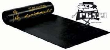
این نوع ایزوگام از دو لایه ی حامل ، شامل تیشوی نخ دار با نخ های شیشه و پلی استر تشکیل می گردد. نوع ساده آن که بدون روکش تولید می شود دارای یک لایه فیلم پلی اتیلن محافظ می باشد که از چسبندگی عایق در هنگام تردد جلوگیری می نماید. از انواع متداول آن می توان به ایزوگام فویل دار ( با روکش فویل ) نام برد.
